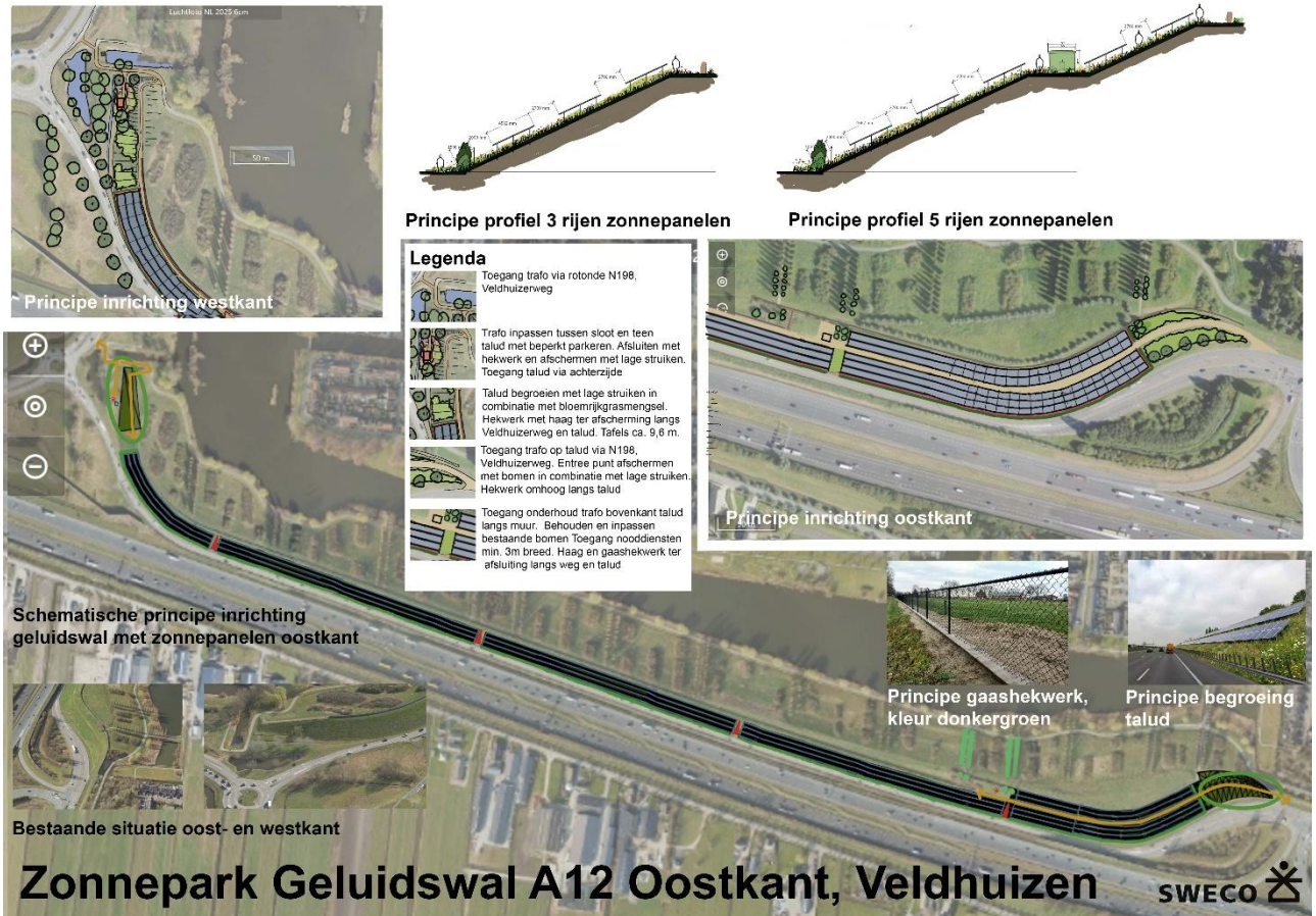
Figuur 9: Landschappelijke inpassing zonnepanelen op geluidswal Veldhuizen.
