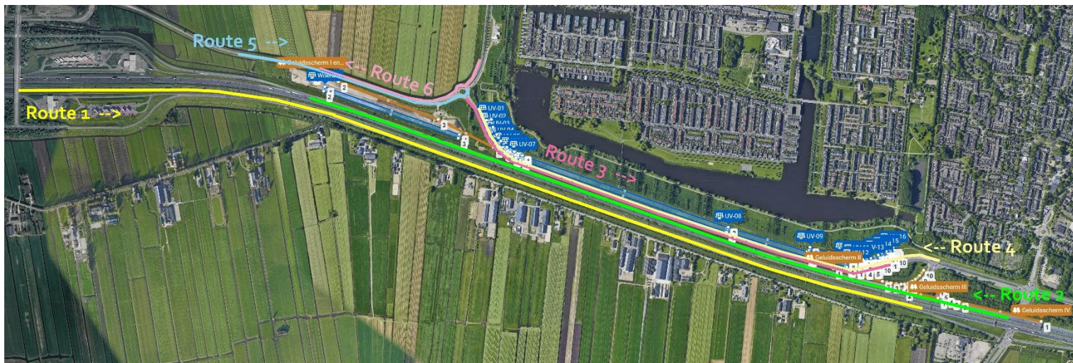
Figuur 4.1: Ingetekende zonnepark (transparant blauwe vlakken) met daarbij de zes routes waarvoor de reflectie berekend wordt en de obstructions in oranje.
