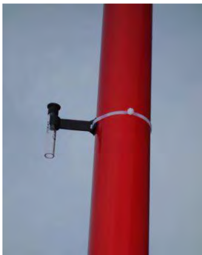
Palmes buisje in houder bevestigd aan regenpijp (links) en aan lantaarnpaal (rechts)
