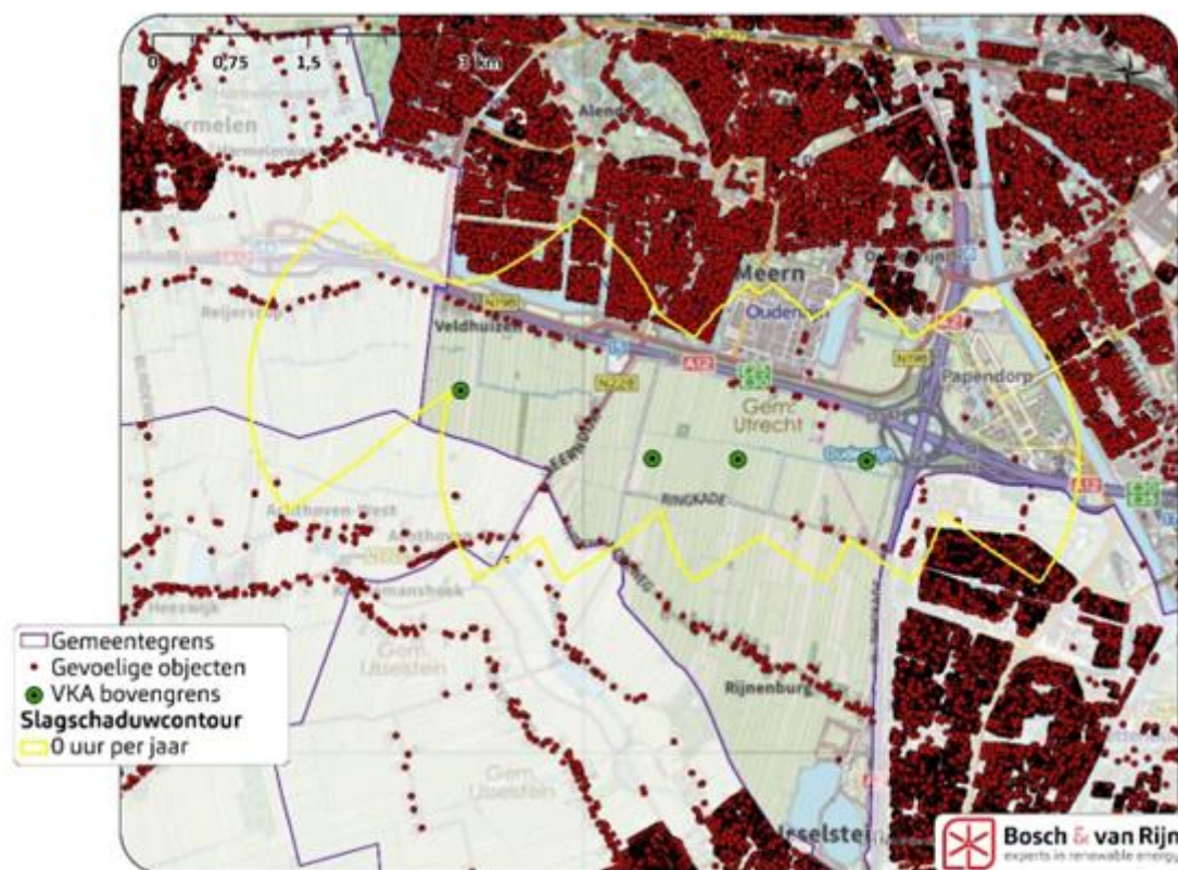
Figuur 23 De 0 uur per jaar 'hinderlijke slagschaduw'-contour van de bovengrens afmetingen windturbines. Hierbij zijn ook nabijgelegen woningen (gevoelige objecten) weergegeven
